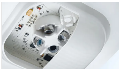
4 pyrodétecteurs numériques avec DSP (Digital Signal Processing)
