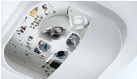
4 pirometri con DSP (Digital Signal Processing)
